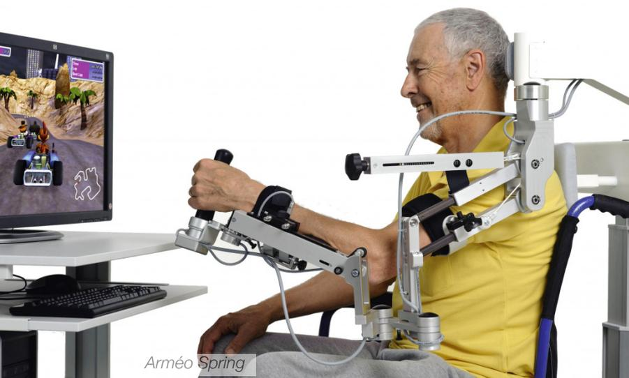
Le Docteur Bernard Bordet a notamment développé au sein de l'établissement l'exosquelette *Arméo Spring*. **Il s'agit d'un des robots les plus aboutis dans la rééducation du membre supérieur qui déleste le poids du membre supérieur.** Non motorisé, l'exosquelette permet une répétition intensive des mouvements.
